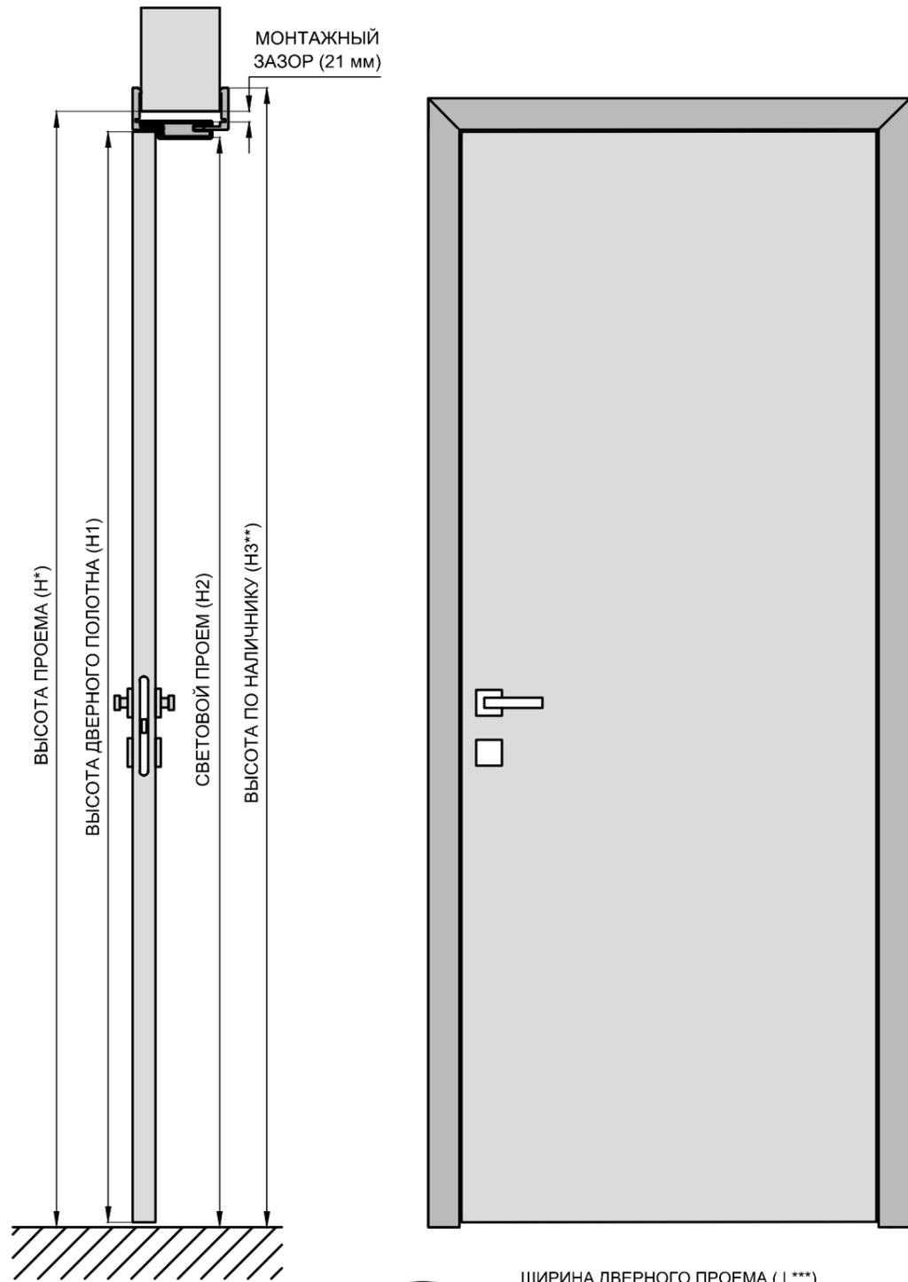
Таблицы соответствия размеров дверных блоков и проемов
