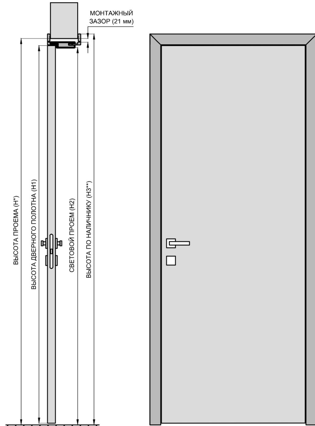
Таблицы соответствия размеров дверных блоков и проемов
